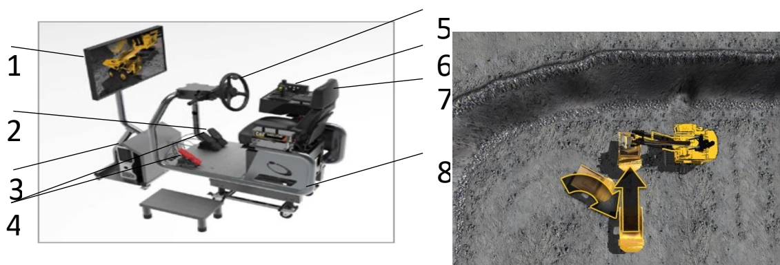
Общий вид симулятора и виртуальная машина для управления (Освоение профессиональных компетенций «Оператор карьерного самосвала»)
